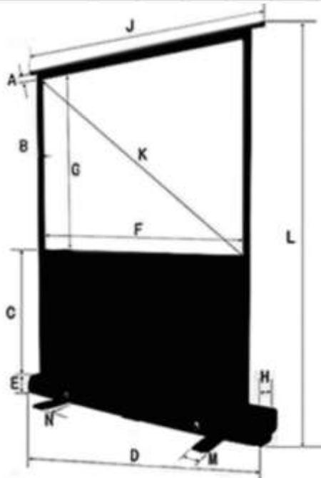
Черное поле под проекционной поверхностью (Extra Drop) позволяет устанавливать экран и на пол, и на стол, настроить экран по высоте.
